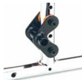
Eje atrasado Centro de gravedad -50mm Silla más estable
